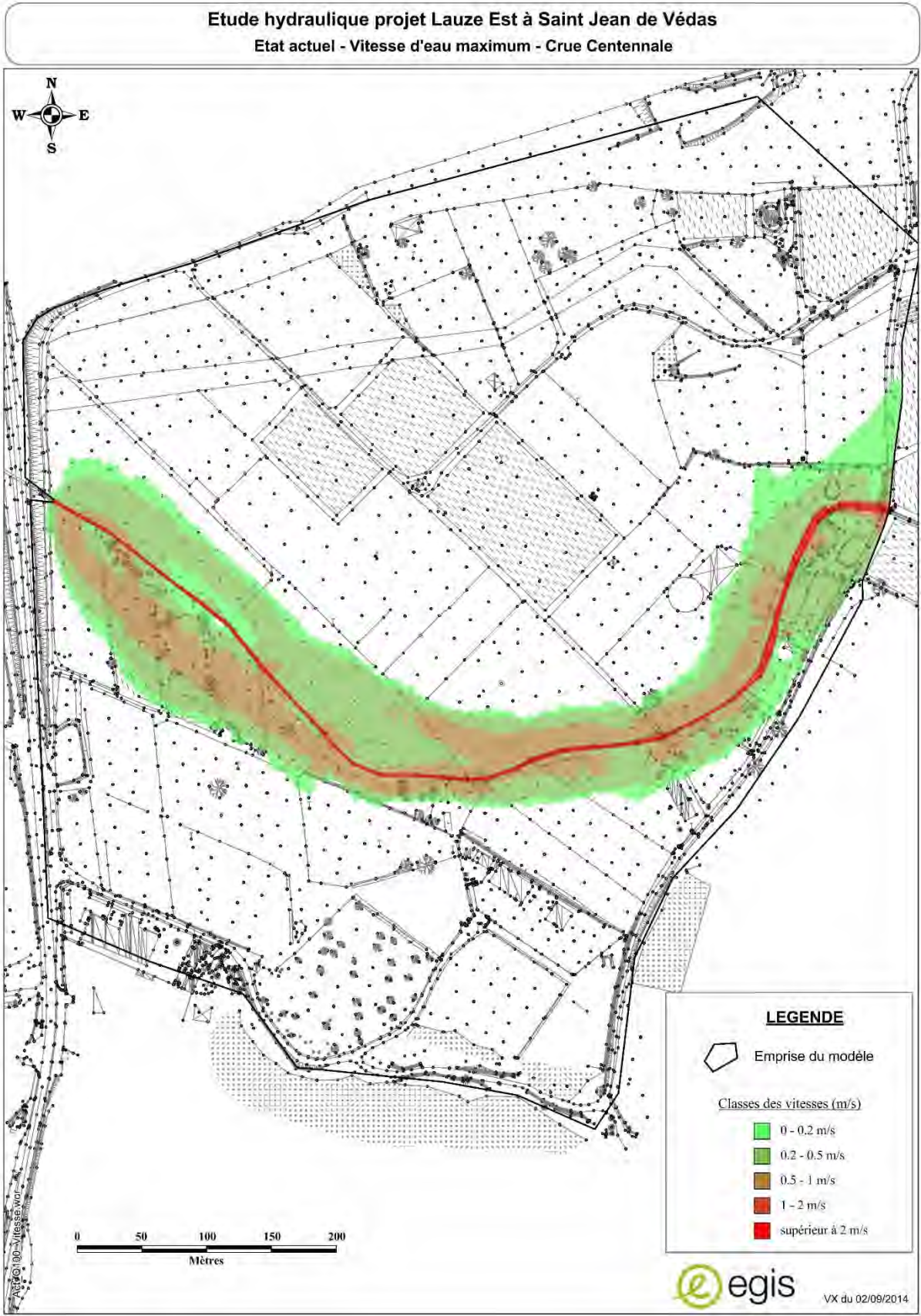
Figure 112 : Comparaison des vitesses maximales d'écoulement entre situation actuelle et projetée pour Q100
