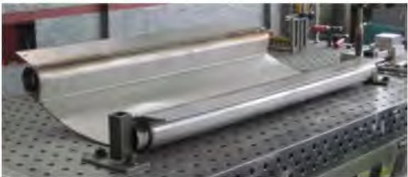
Figure 23 : Échangeur installé dans un ovoïde existant (Rabtherm), échangeur pour collecteur existant (Uhrig) (Source : Lyonnaise des Eaux)
