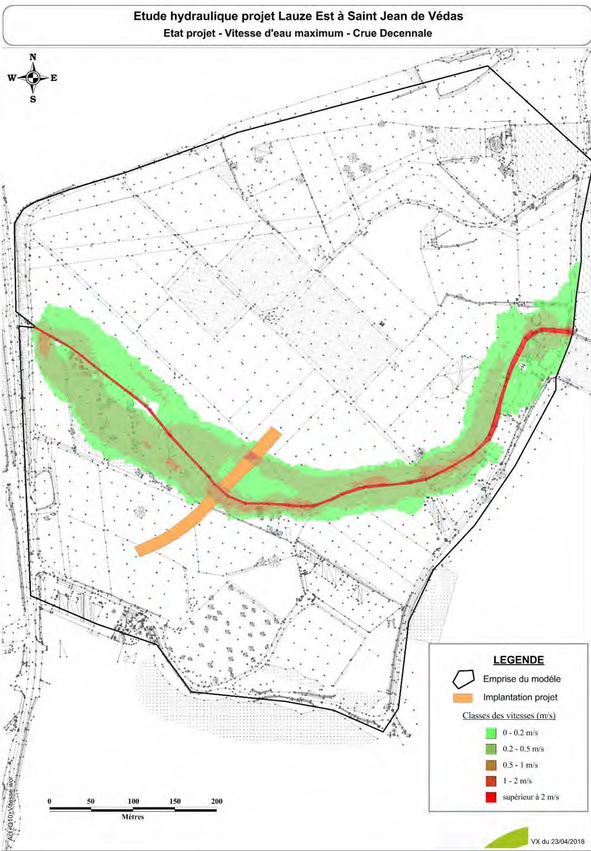
Figure 110 : Comparaison des vitesses maximales d'écoulement entre situation actuelle et projetée pour Q10
