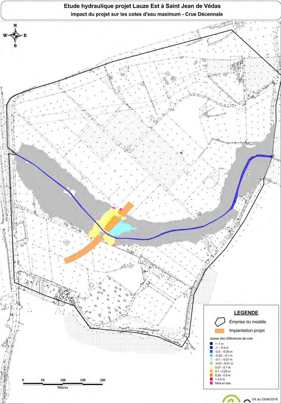
Figure 115 : Impact du projet sur les cotes d'eau maximales pour Q10
